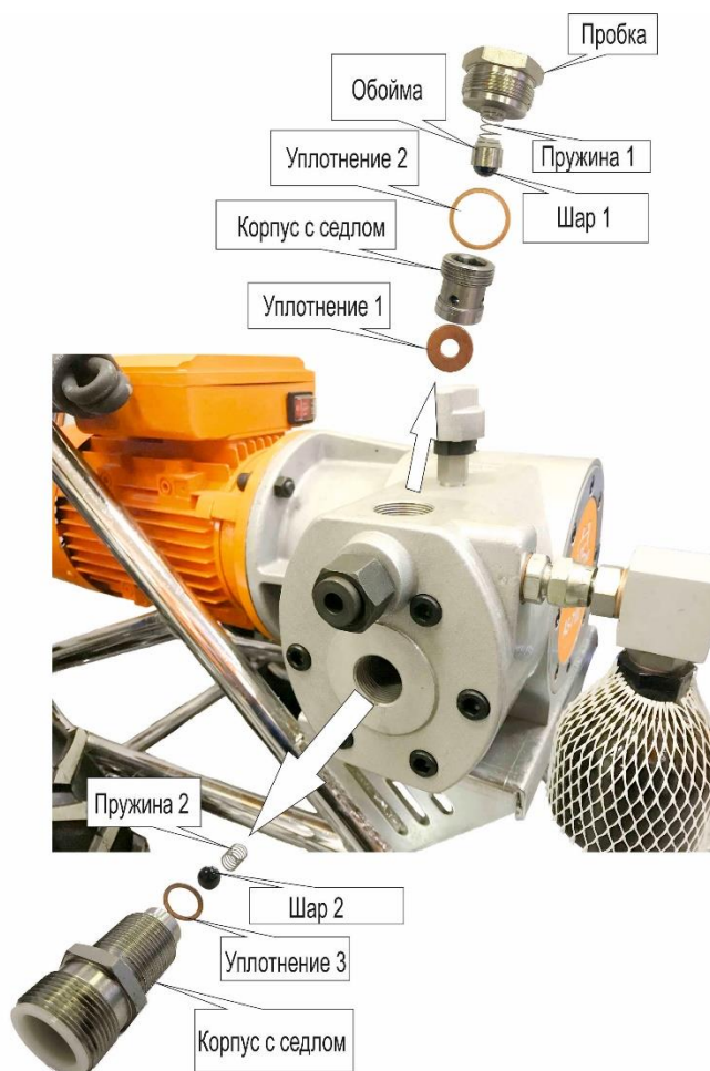
Рис.14 Схема расположения частей клапанов.
